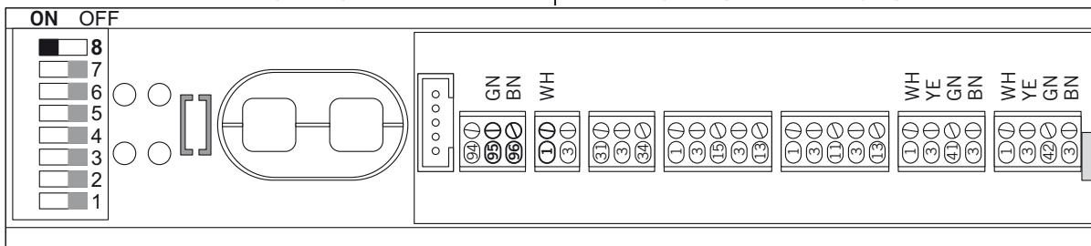
Schéma des connexions du verrouillage et du générateur d'impulsions sur le CS 80 MAGNEO (uniquement par un personnel dûment qualifié !)
