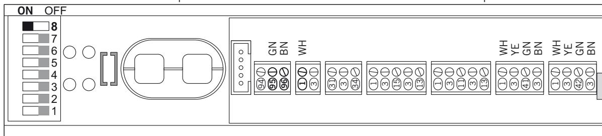
**Piano elettrico per il collegamento del blocco e dell'attivatore a CS 80 MAGNEO
