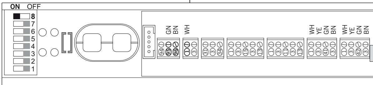
**Anschlußplan Verriegelung und Impulsgeber an CS 80 MAGNEO
